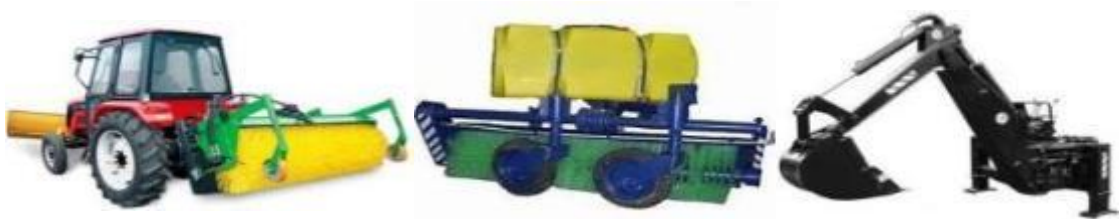
Рис. 4.4. Навісне обладнання для трактора: щітка, ємність для зрошення, екскаватор
