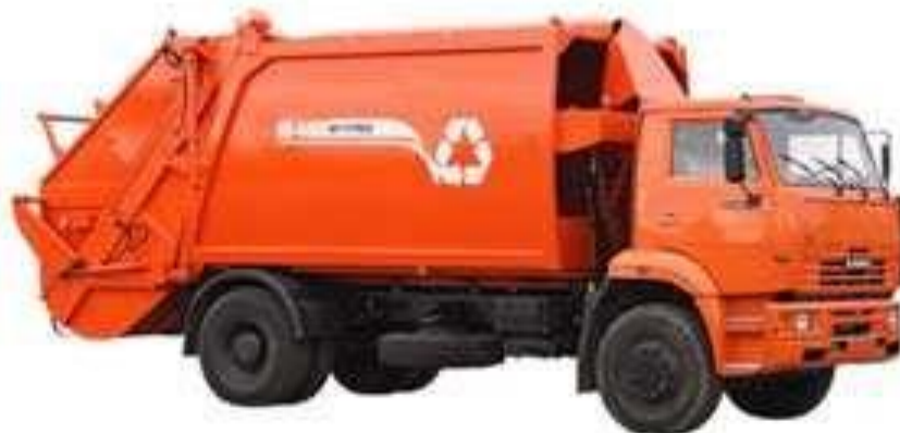
Рис. 2.9. Смітєвоз з заднім завантаженням КО-440В
